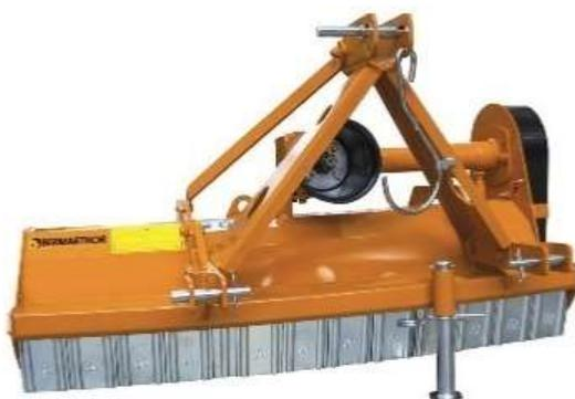
Acoplamento aos 3 pontos fixo e reversível, Cat. I
