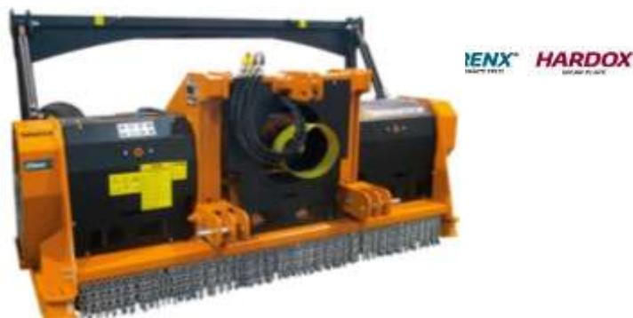
Acoplamento aos 3 pontos fixo, Cat. II-III
