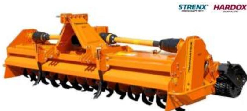
Acoplamento aos 3 pontos Cat. I
