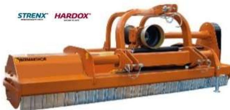
Acoplamento aos 3 pontos descentrável e reversível, Cat. II
