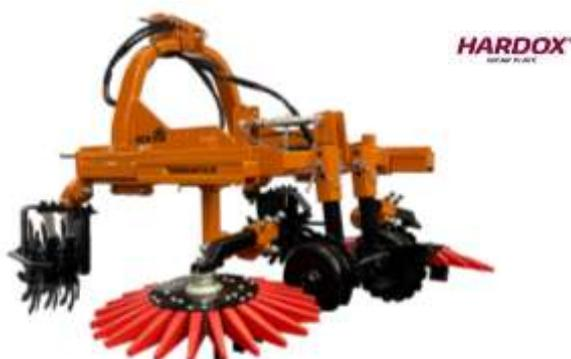
Acoplamento de 3 pontos reversível, Cat. I-II
