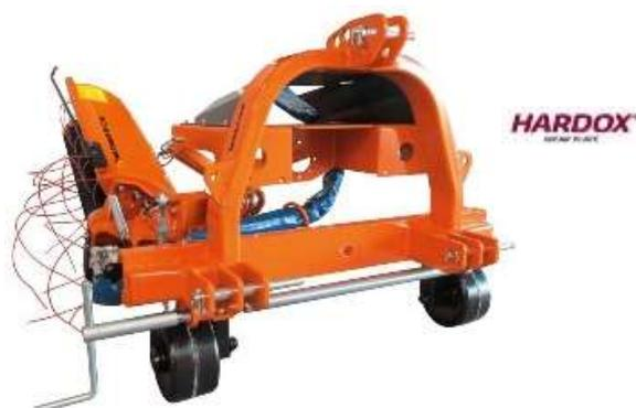
Estrutura independente com acoplamento aos 3 pontos Cat I-II
