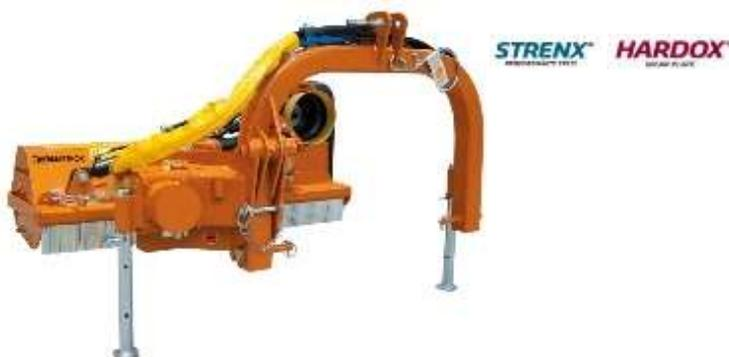
Acoplamento aos 3 pontos Cat. I com sistema de flutuação e dispositivo de segurança
