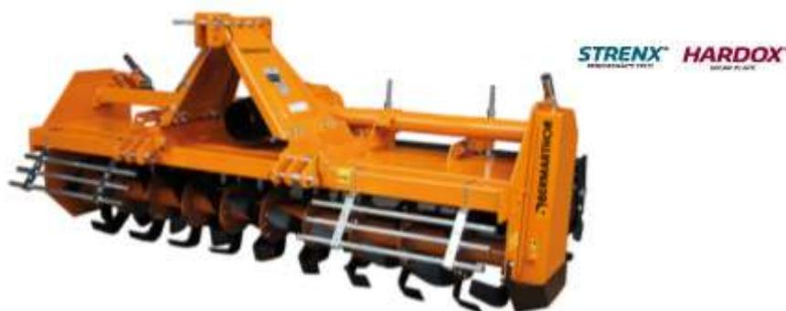
Acoplamento aos 3 pontos Cat. I
