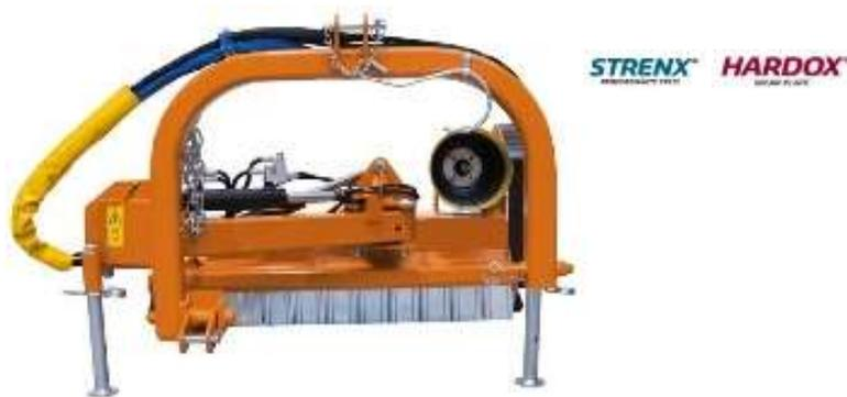
Acoplamento aos 3 pontos Cat. I
