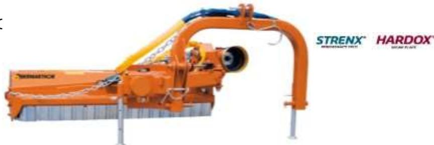
Acoplamento aos 3 pontos Cat. II com sistema de flutuação e dispositivo de segurança
